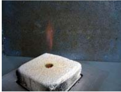
⑭炉内温度 1050°Cくらいで天蓋の小穴から還元の炎が現れてきます
